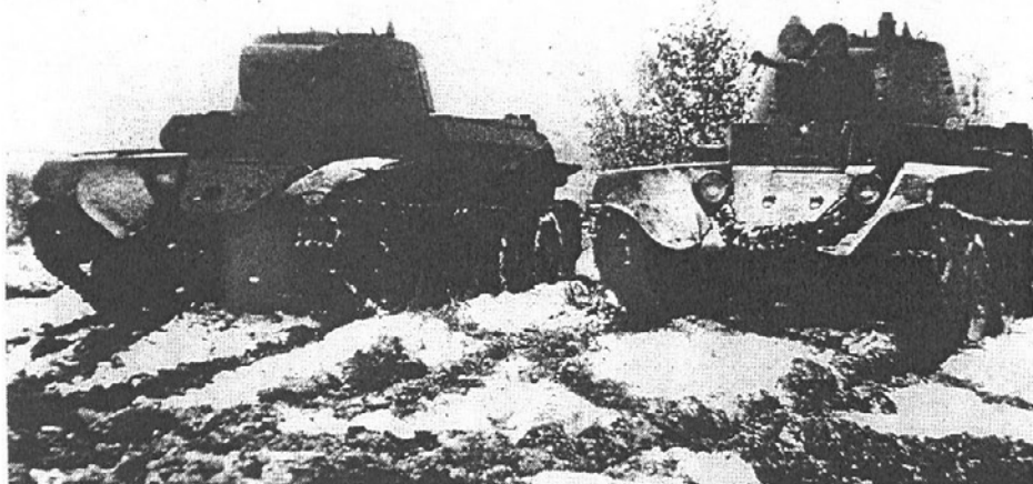
Телемеханическая группа танков на базе БТ-7.
