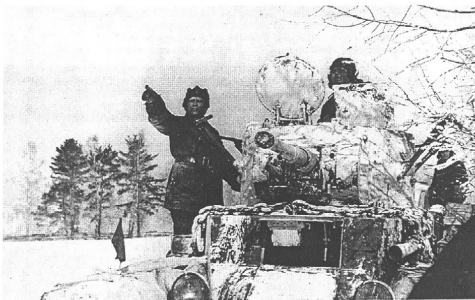
На учениях Московского военного округа. 1937 год. БТ-7 с цилиндрической башней и зенитной установкой пулемета, о чем говорит круглая крышка правого башенного люка.
